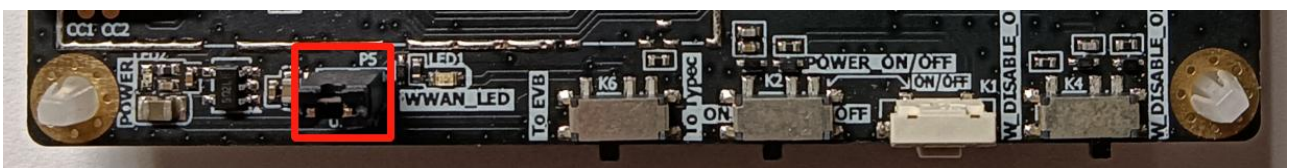
图 3.14 5G-ADP 3.3V LDO 输入选择接口实物图
