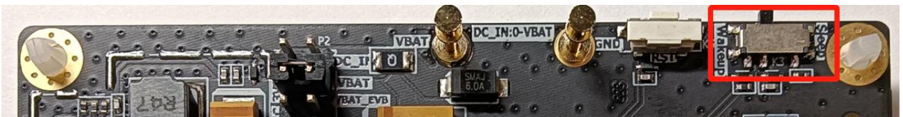
图 3.9 5G-ADP 唤醒&休眠开关实物图
