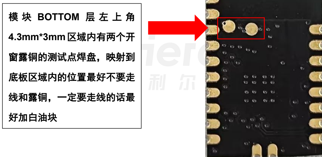
图 5.2 模组底部测试点焊盘位置
