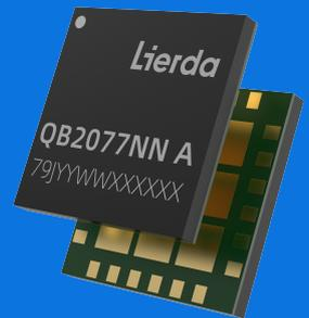
QB20系列芯片是基于SX1262平台开发的LoRa SiP芯片，8mm\*8mm超小尺寸、支持470/868/915M频点，全频段封装兼容，最大功率到22dBm，可外接32MHz TCXO或无源晶振，可适用于小尺寸需求的可穿戴设备、低功耗传感器、工业控制、无线遥控等各类IoT应用场景。
