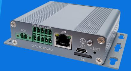
利尔达TE310 RedCap终端是面向工业互联网+应用而研发的一款集5G网络、千兆网口、Wi-Fi6于一体的通信产品，支持带耳锁紧电源接口、以太网接口、USB接口、RS232接口、RS485接口、DI/DO接口。支持5G LAN、URLCC、高精度B码授时功能，旨在为用户提供最快速、便捷地使用体验。
